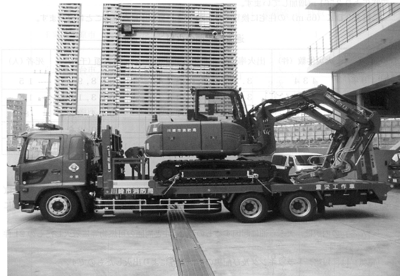
新型車両「震災工作隊」（搬送車両と双腕作業機）
